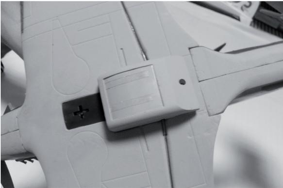
Installieren Sie den Akku und schließen Sie die Servokabel am Empfänger an.
