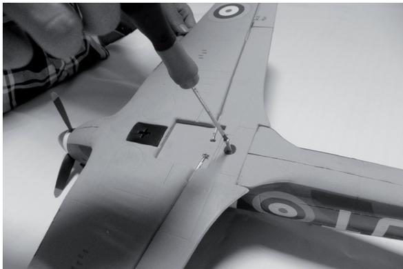
Befestigen Sie die Tragfläche mit der im Lieferumfang beiliegenden Schraube am Rumpf.
